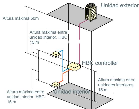
Ⓡ : Tubería refrigerante    ⓐ : Tubería Agua
